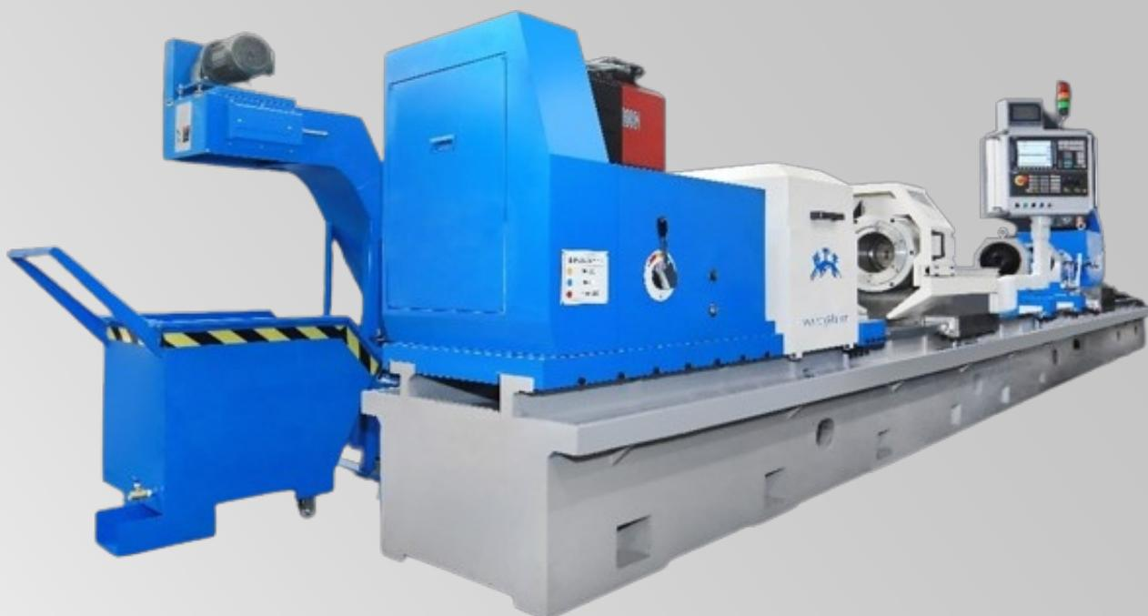
Станки предназначены для глубокого сверления, рассверливания, развёртывания и раскатывания глубоких отверстий расположенных по оси деталей - тел вращения, по технологии ВТА.
